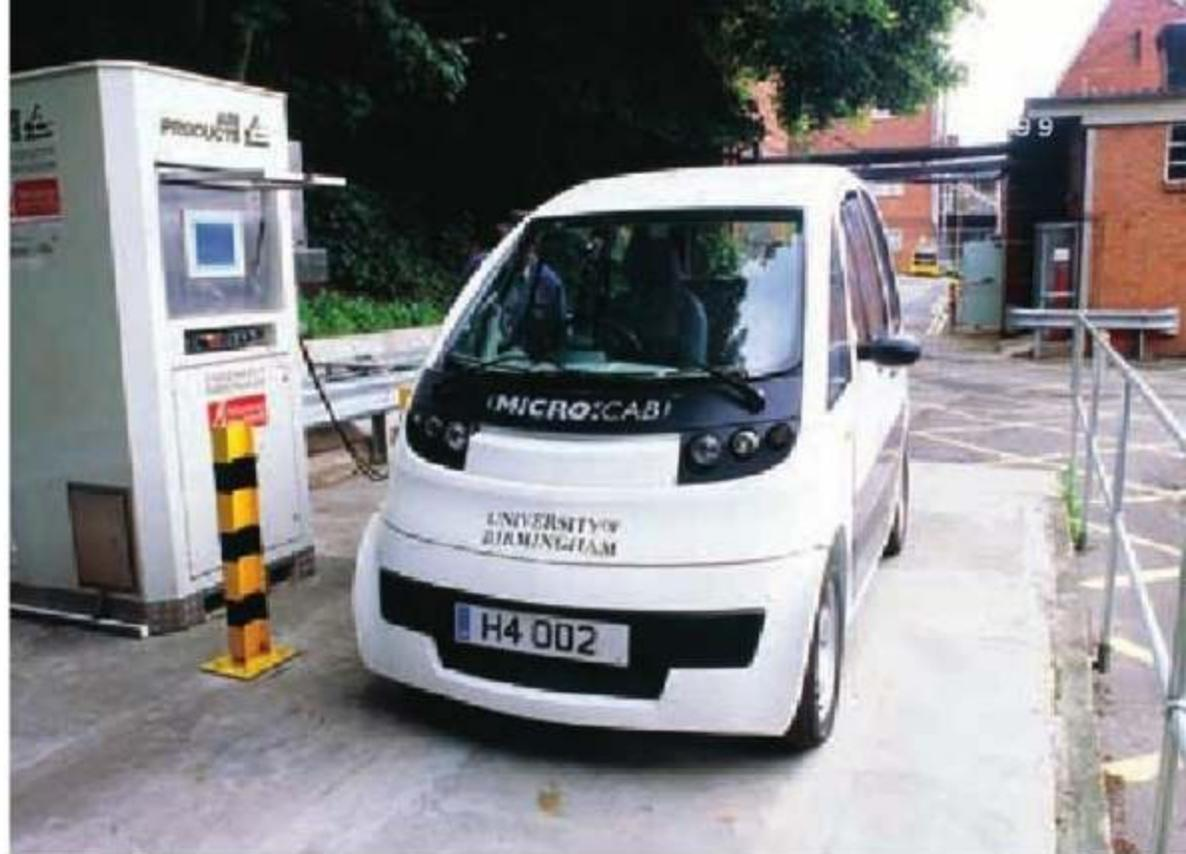
Un automóvil, cuyo combustible es el hidrógeno, funciona como uno eléctrico, pero lo alimenta una pila de hidrógeno, material que se combina con el oxígeno del aire en una celda para generar electricidad. Existen dos tipos de motores que emplean hidrógeno: los motores de combustión, que lo utilizan como si fuera gasolina, es decir, lo queman en un motor de explosión, y los motores de conversión de pila de combustible, que utilizan el hidrógeno para producir electricidad.
