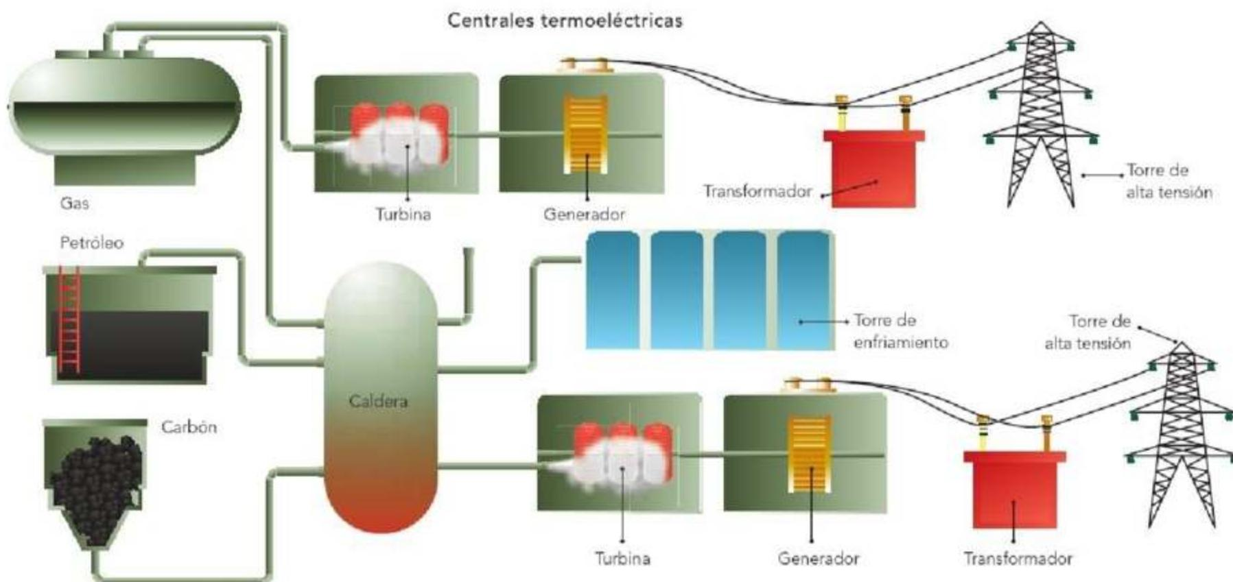
Muchas de estas centrales eléctricas utilizan carbón como combustible para calentar el agua. El vapor que sale de las calderas hace girar las aspas de grandes turbinas. Estas turbinas se encuentran conectadas a otras máquinas llamadas generadores, que producen electricidad al ponerse en movimiento. La energía que se genera en la central eléctrica se
