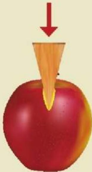
Hay materiales que no se pueden partir fácilmente. Para hacerlo se utiliza una herramienta llamada cuña, que es una máquina simple. Se trata de una pieza de madera o metal en forma de prisma triangular. Una de sus aristas es filosa y se utiliza para dividir cuerpos sólidos.
