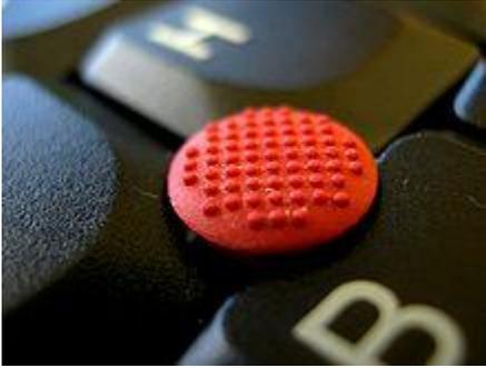
(Varita apuntadora) Un dispositivo de puntero es un pequeño joystick que se utiliza como dispositivo de puntero montado típicamente en el centro de un teclado de computadora.
