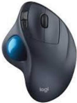
El trackball o bola de seguimiento es el dispositivo apuntador estacionario, compuesto por una bola incrustada en un receptáculo que contiene sensores que detectan la rotación de la bola en dos ejes.
