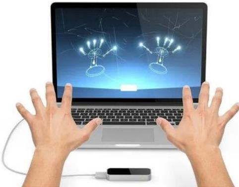
Dispositivo sensor de hardware de computadora que admite movimientos de manos y dedos como entrada, de forma análoga a un mouse, pero no requiere contacto con las manos o conmovedor.
